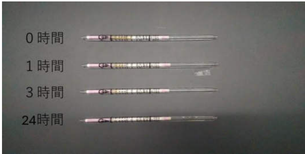
図4 ホルムアルデヒド吸着試験に用いた検知管の変色の様子
