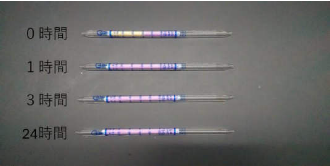
図 3 アンモニア吸着試験に用いた検知管の変色の様子
